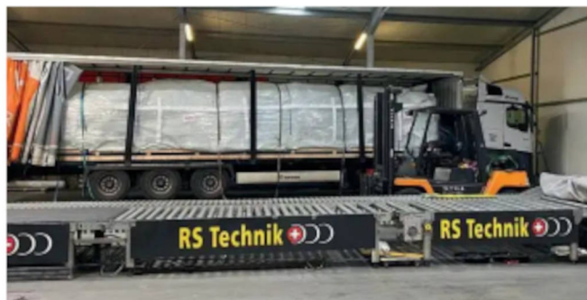
Anlieferung: Entladung der bis zu 9 t schweren Liner mit der Imprägnierstraße im Vordergrund | Foto: RS Technik
